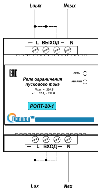
Рис.1 Схема подключения модуля к сети с рабочим током до 20 А.
